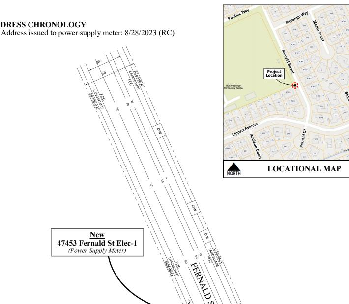
0+24' O/S 2' ANCHOR 0+11 O/S 2' NEW UG POWER SUPPLY TRENCH 6'± 0+05 O/S 2' EXISTING UTILITY POLE (TIE-IN) 0+00 END D/W
